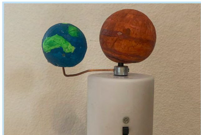
Abb. 2. Discokugel-Motor zur Realisierung der Bewegung des Exomonds um den Exoplaneten
