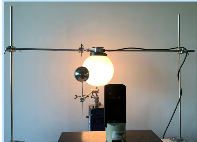
Abb. 1a. Aufbau eines Analogieexperimentes zur Suche nach Exoplaneten
